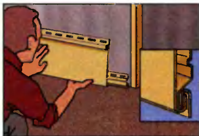
Рис. 14. Установка первой панели сайдинга.
