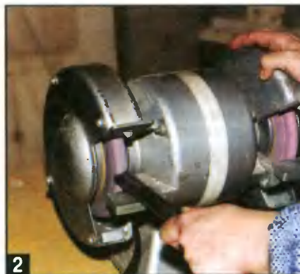
2 Обработал концы трубы с помощью электроточила.
