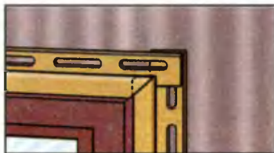
Рис. 13. Формирование углов на J-планках.
