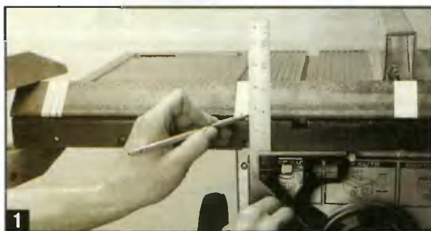
Прижимают стальной уголок к столу пилы и переносят положение отверстий и пазов со стола на уголок.
