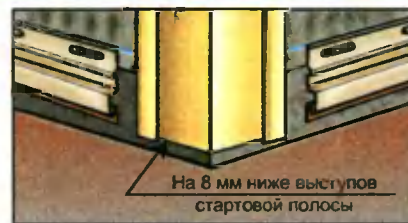
Рис. 8. Установка внешних углов.
