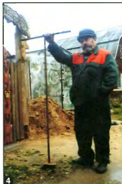
4 Самодельный ручной садовый бур в сборе.
