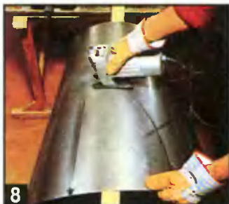
8 Проем во внешнем колпаке и внутреннем экране вырезают электролобзиком по размерам, указанным на «выкройке» (см. рисунок).
