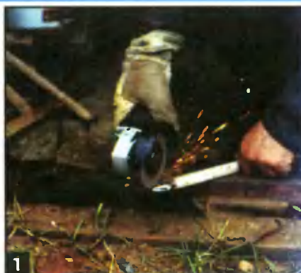
1 Сплюснул нижний конец длинной трубы и заострил его с помощью угловой шлифовальной машинки, сварил кромки.
