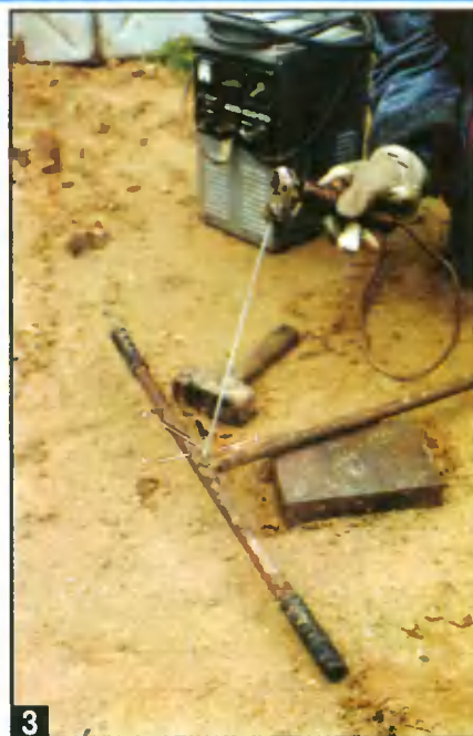
3 Приварил рукоятку к верхнему концу трубы, а ножи — к нижнему.
