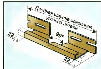
Рис. 9. Изготовление крышки для внешних углов.
